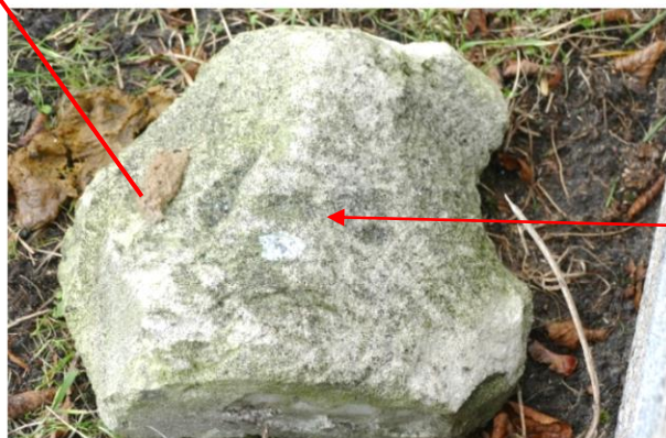
11a. Trudny do określenia fragment elementu wykonanego z zaprawy mineralnej, porowatej (podobieństwo do „celolitu” – materiału znanego w latach 20- tych XX wieku).
