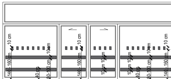
Ryc. 2.4. Umiejscowienie oznaczeń na taflach przeszklonych drzwi ( oprac. autora )
