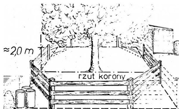
Rys. 3. Wygrodzenie drzew (Zieleń miejska nr 11/2009 (32) artykuł „Zagrożenie dla drzew na placach budów cz. I”)
