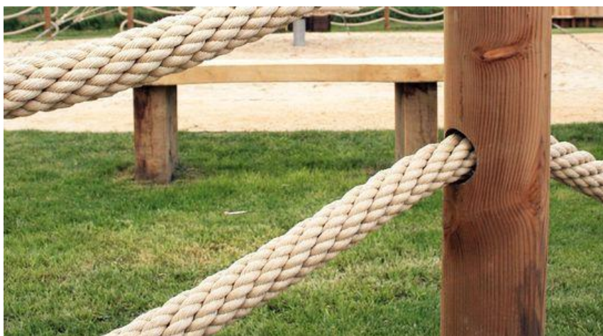
Ryc. nr 3 Lina polipropylenaowa z rdzeniem stalowym Źródło: Internet
